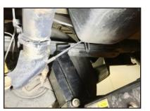
**STEP 4:** Remove lower shock bolt.
