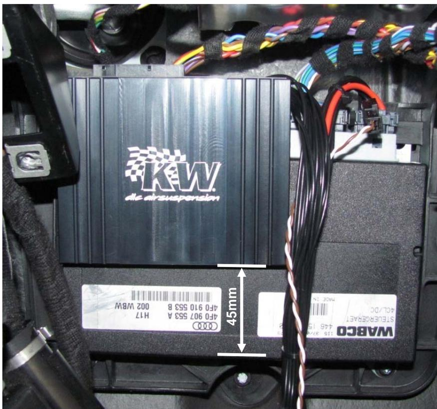
KW DLC Modul mit Klettband befestigen.
