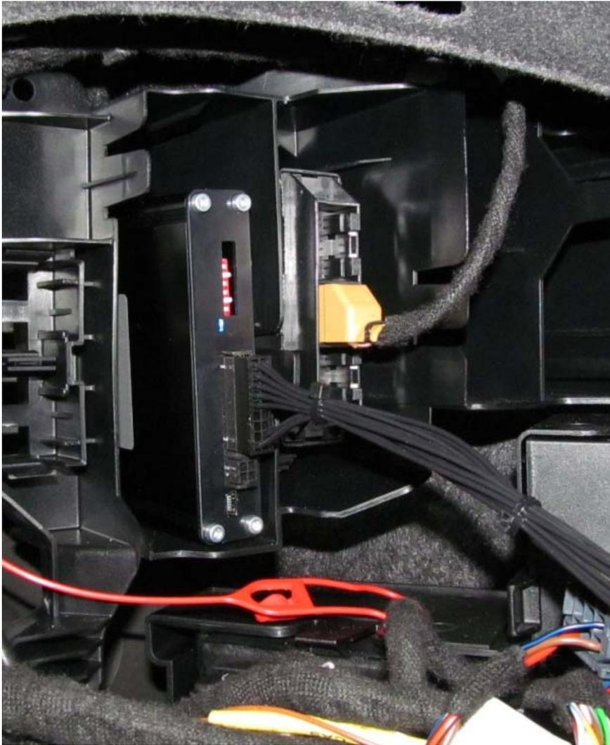
KW DLC Modul mit Klettband befestigen. Den vom Kabelbaum abgehenden Stecker (18-polig) in das KW DLC Steuergerät einstecken.
