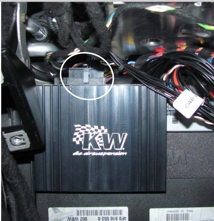
Den vom Kabelbaum abgehenden Stecker (18-polig) in das KW DLC Steuergerät einstecken.
