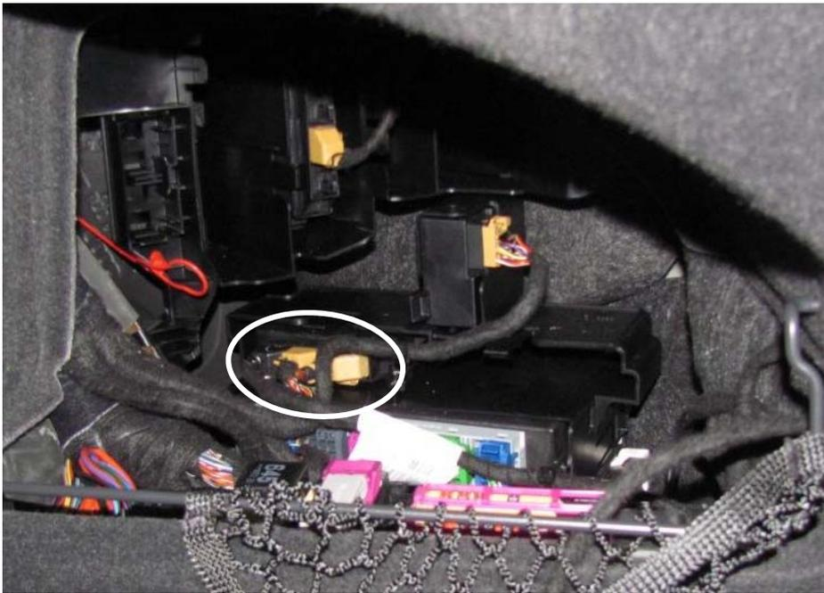
16 poliger Stecker aus dem PDC Steuergerät ausstecken und Stecker Gehäuse demonstrieren.
