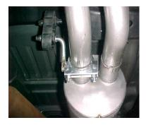
INSTALL REAR MUFFLER HANGER # H ONTO DRIVER SIDE OUTLET OF THE MUFFLER AND INSERT THE WELDED HANGER INTO RUBBER GROMMET.
